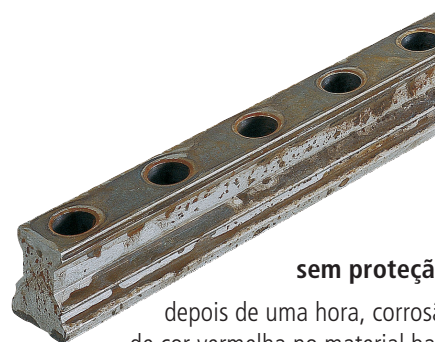
Trilho com e sem proteção depois de um ensaio de névoa salina segundo DIN 50 021
