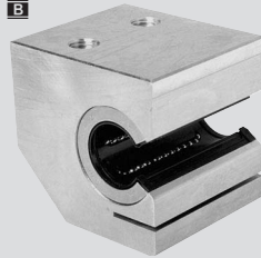
Kit Linear 1034- execução Tandem aberto, ajustável, alumínio com dois RLE Super A
